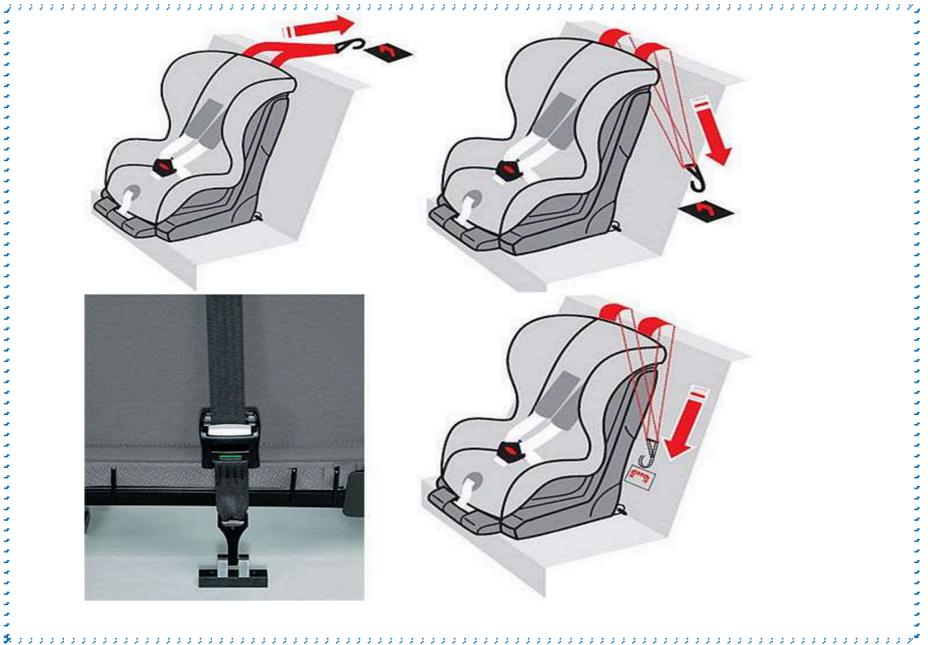
Рисунок 7. Способы фиксации якорного крепления
